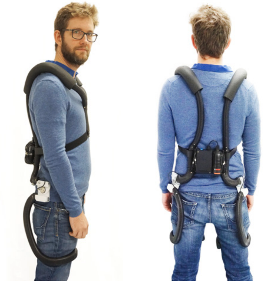
CareJack in Seitenansicht mit arretierbarem Hüftgelenk und Beinbügel (links) und von hinten, mit Akku (rechts) und Recheneinheit
